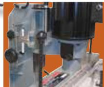
Arrêt en hauteur et en profondeur réglable
